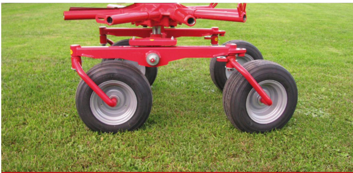
Doppia ruota per il modello RR 350 TANDEM. / Tandem axles with pivoting tires on RR 350 TANDEM. / Doble ruedas tándem en el modelo RR 350 TANDEM. / Double roue pour modèle RR 350 TANDEM.
